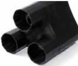
Fabricadas con poliolefina de cadena cruzada de pared gruesa, revestida con adhesivo tipo hotmelt. Consisten en un tubo pre-moldeado que tiene un cuello y tres fases de salida. Se utilizan como sello para la transición entre el ducto metálico o plástico y los cables que salen de ella, evitando la penetración tanto de humedad como de objetos extraños y animales. También se utilizan como protección mecánica y ambiental en cables armados de varias fases.
