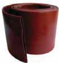
Los productos termocontráctiles de esta familia, están diseñados para cubrir barras de distribución eléctrica en donde se requiera un semi aislamiento que permita reducir la distancia entre fases. Este material presenta excelentes características de retardo a la flama y resistencia a la degradación por los rayos UV lo cual permite que sean aplicadas en exteriores.
