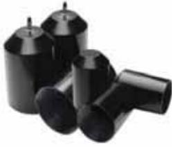
Los capuchones termocontráctiles son fabricados en poliolefina de pared dual revestida con adhesivo tipo hotmelt para proveer un aislamiento eléctrico en baja tensión (1000 V) así como un sello hermético contra la humedad.
