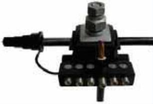
El kit consiste en un conector aislado multiderivador modelo S-MC que se acopla al S-IPC para ofrecer rápidamente múltiples derivadas. Las derivadas se conectan por medio de opresores tipo allen. Los conectores multiderivadores cuentan con un electroestañado de alta conductividad para aumentar la resistencia a la corrosión e intemperismo permitiendo conexiones en conductores tanto de cobre como de aluminio.
