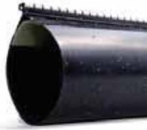
Fabricada en poliolefina con pared dual revestida con un adhesivo interno tipo hotmelt; adicional tiene una “lengüeta” de adhesivo para proporcionar un excelente sello entre cables; contiene un cierre metálico y el espesor es de pared gruesa, proporcionando alta resistencia a la abrasión, rayos U.V., corrosión y químicos generales. Son utilizadas principalmente para aislar y sellar derivaciones a media línea sin cortar el cable principal, en cables de baja tensión.
